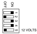
NOTE: FACTORY SET 5 SECOND DELAY IS SHOWN IN DRAWING SW#1 SW#2 SW#3 SW#4 TIME
